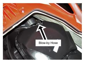
Remove air intake silencer baffle (pull up). Set aside.
